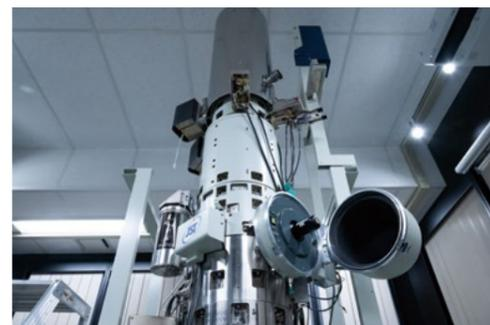
■ 新開発の原子分解能磁場フリー電子顕微鏡
