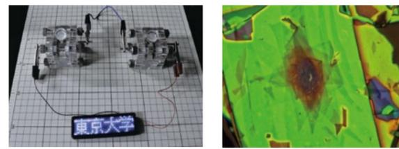
鉄族金属硫化物と炭素の複合材料を触媒に用いた重鉛空気電池
