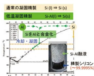
■太陽電池原料用シリコンの低温凝固精製法
