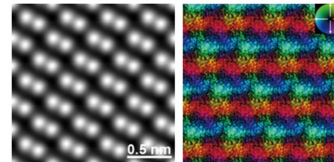
■  $\alpha$ -Fe<sub>2</sub>O<sub>3</sub> 結晶の原子像 (左) と磁場カラーベクトル像 (右)
